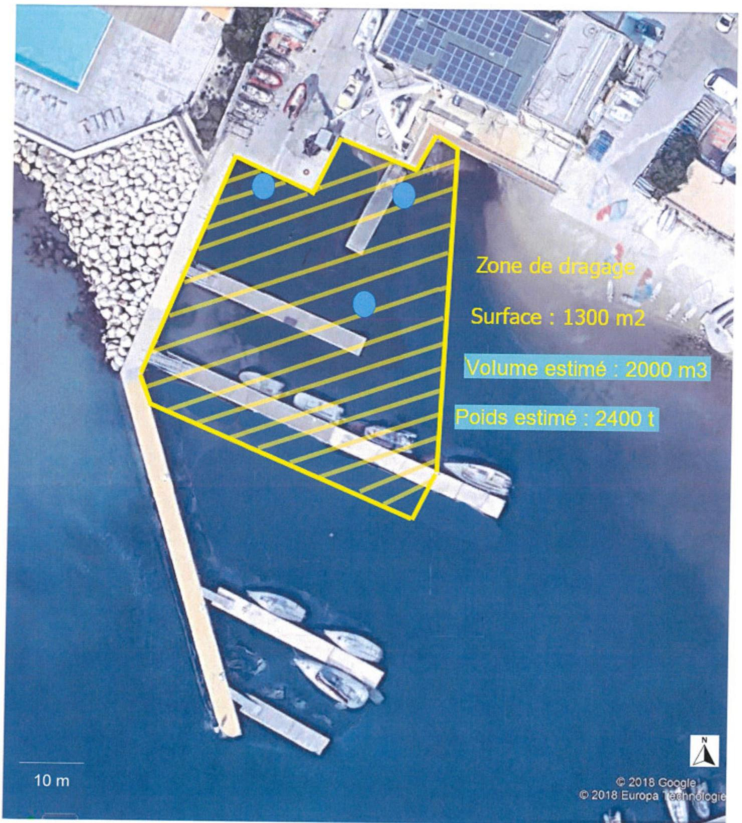
● Échantillonnage pour analyses sédimentaires à la côte de dragage -2m (côte marine)
